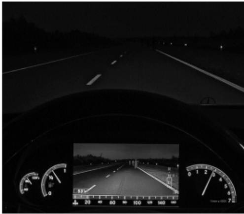
de display met infrarood nachtzicht
